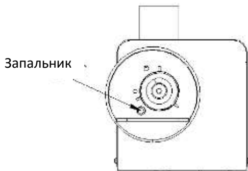
Рисунок 10 Правильное положение запальника
